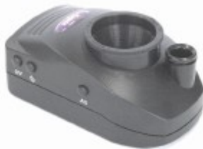
model 1019M - białe światło, UV 365, UV 313, UV 254, światło retrorefleksyjne 3M, światło AS (antystokesowskie). Dostępny w wersji ze skalą (model 1019M.01).
