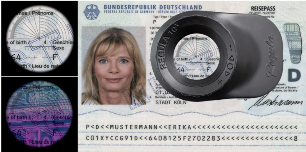
Regula 1004MU na stronie paszportu - źródła światła LED: białe ukośne, ultrafioletowe 365 nm - powiększenie 10x
