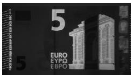
Padający cjan 505 nm - powiększenie 1,6x
