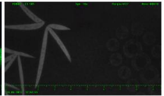
Fragment badanej banknotu w intensywnym świetle sycylijskim (505 nm). Powiększenie 16x na monitorze.
